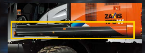
Боковые лонжероны D-образного сечения
