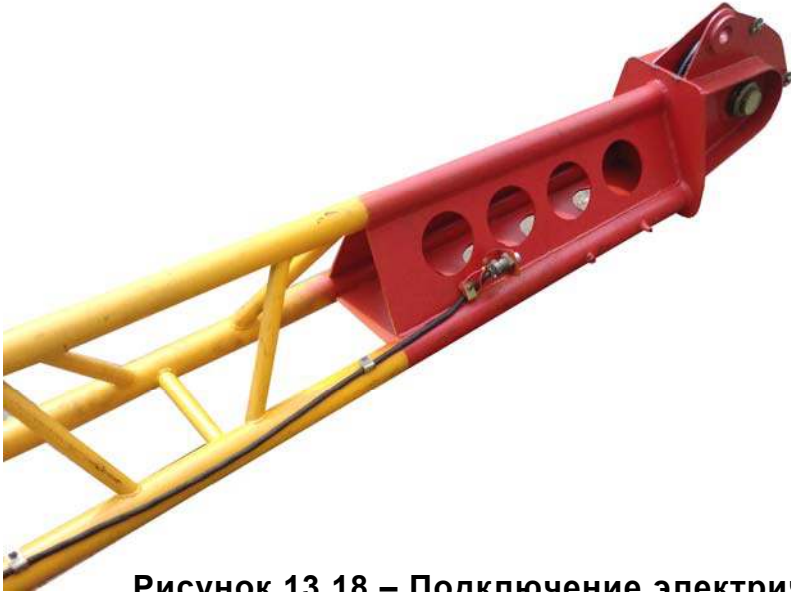
Рисунок 13.18 – Подключение электрического кабеля на гуське
