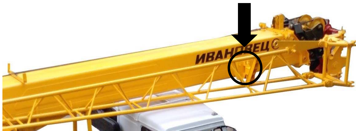
Рисунок 13.37 – Установка пальца в кронштейн на оголовке стрелы
