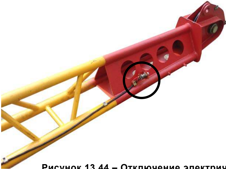
Рисунок 13.44 – Отключение электрического кабеля на гуське
