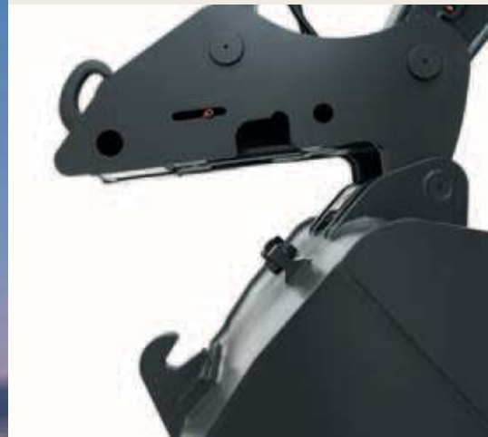
• Гидрозамки 3 видов, позволяют применять широкий спектр навесного оборудования
